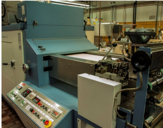
Abbildung 6: Fertigung eines Textils zur PDI am Spann-Trocken- und Fixierrahmen des TITV Greiz
